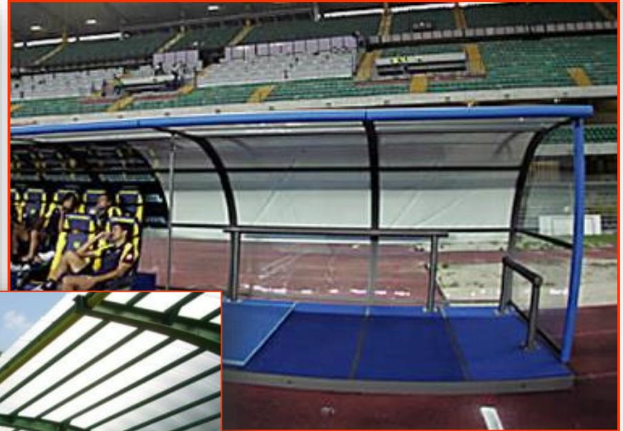
Поликарбонат - материал, который идеально подходит для изготовления легких и прочных навесных конструкций.
